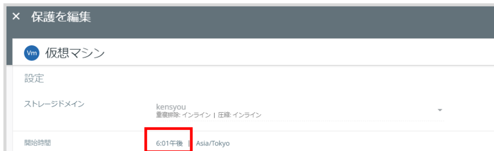
図 12.5.1 バックアップ開始時刻を修正する
